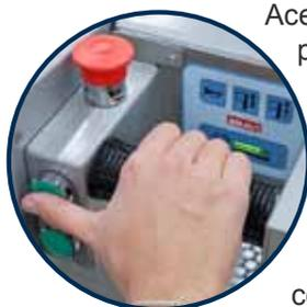
Aceleración de avance / retroceso es proporcional y esta colocado cerca de botón de elevación y descenso de la cesta, para hacer posible estos movimientos, incluso durante la marcha. Todas las funciones se activan sin necesidad de mover la mano del acelerador, para mayor comodidad del operador.
