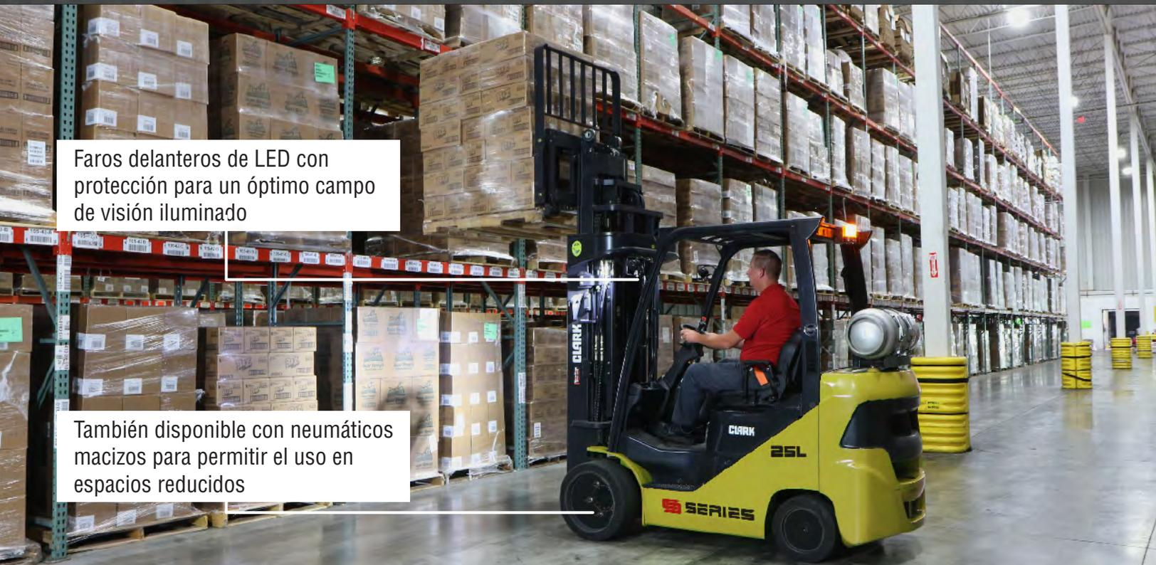
Faros delanteros de LED con protección para un óptimo campo de visión iluminado
