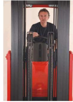
Los operarios tienen una excelente visibilidad hacia delante gracias al mástil triplex con elevación libre con sus dos cilindros laterales. La inclinación del mástil ayuda a cargar palets incluso sobre camión.
