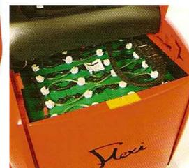
Una ligera elevación y salida hacia fuera para un cambio rápido. Un buen acceso a la tapa de la batería. Sin motores debajo.
