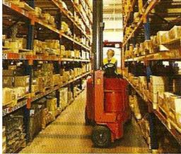
Chasis en anchos de 1250mm y 1350mm permiten elevaciones más altas con cargas más pesadas. Y la potencia de AC para una rápida velocidad de traslación.
