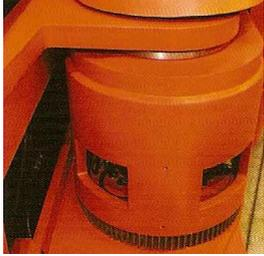
Diseñada para permitir un apilado de precisión por encima de 10 metros, combinando una articulación de 220° con una fiabilidad de 2.5 toneladas.
