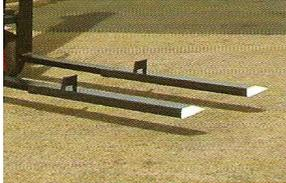
Horquillas telescópicas proporcionan hasta un 50% más de capacidad de almacenamiento que las carretillas retráctiles.
