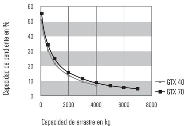
El diagrama de capacidad de pendiente muestra la combinación de capacidad de arrastre y de pendiente del tractor de arrastre.
