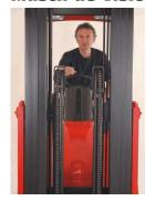
Los operarios tienen una excelente visibilidad hacia delante gracias al mástil triplex con elevación libre con sus dos cilindros laterales. La inclinación del mástil ayuda a cargar palets incluso sobre camión.
